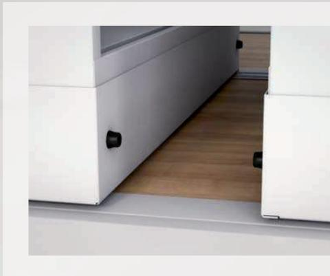
Base equipada con 2 raíles con sistema antivuelco, tarima de melamina chapada a doble cara de 19mm, sistema de nivelación de hasta 30mm y una resistencia total de 5.000kg por plataforma.
