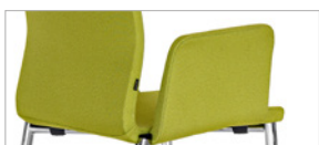
Brazo tapizado con estructura interior (pletina 20 x 6 mm + calibre Ø 8 mm) de acero recubierta de espuma inyectada
